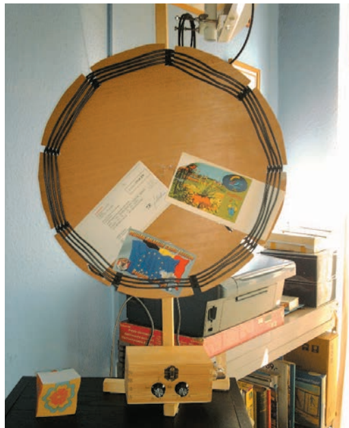
Versie 2. 50 Watt en 45 cm doormeter, 4 mm 2 geleider. QSO met DA2PDM te Potsdam, bij Berlijn in DL.
