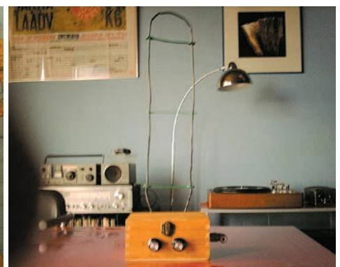
Deze versie is voor de 6 meterband, met 1 meter loop voor 50 Watt gebruik en dat werkt ook netjes...
