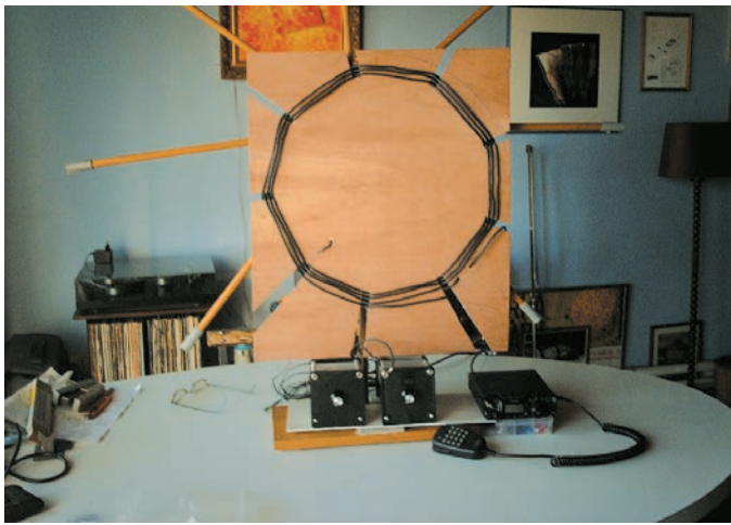
Loop voor 80 meterband, ca 50 cm doormeter en met twee C's 1x 250 pF en 1 x 250+250 pF vlinder, 100 Watt versie.
