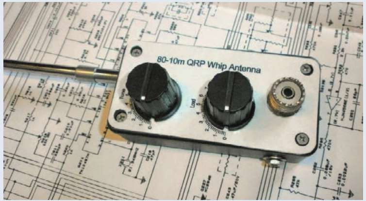
Zelfde constructie als bij het voorgaande prototype. Hier is de voorzijde uitgevoerd in printplaat, met de koperzijde naar binnen. De lay-out wordt afgedrukt op papier, geplastificeerd en op de printplaat gekleefd met dubbelzijdige kleeftape. Il est conçu comme le précédent. Ici, la face avant est réalisée en circuit imprimé, cuivre à l'intérieur. Le décor est imprimé sur du papier qui est ensuite plastifié et collé sur le circuit imprimé avec de l'autocollant double face.
